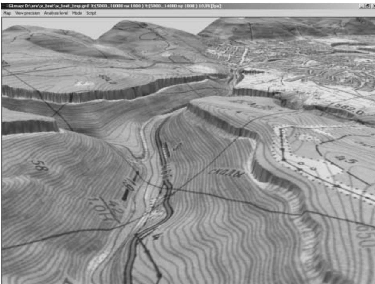
Рис. 2. Пример визуализации рельефа средствами гравитационно-динамической ЦМР с натянутой топографической картой. Масштаб 1:25000
