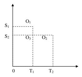
в) В этом случае то же расстояние между городами A и B определяется площадью прямоугольника  $OS_2O_2T_2$ , равновеликого прямоугольнику  $OS_1O_1T_1$ . Прямоугольник  $OS_2O_3T_1$  — общая часть прямоугольников  $OS_1O_1T_1$  и  $OS_2O_2T_2$ , поэтому равновеликими будут прямоугольники  $S_2S_1O_1O_3$  и  $T_1T_2O_2O_3$ . Значит,  $S_2S_1\cdot S_2O_3=T_1T_2\cdot T_1O_3$ .
