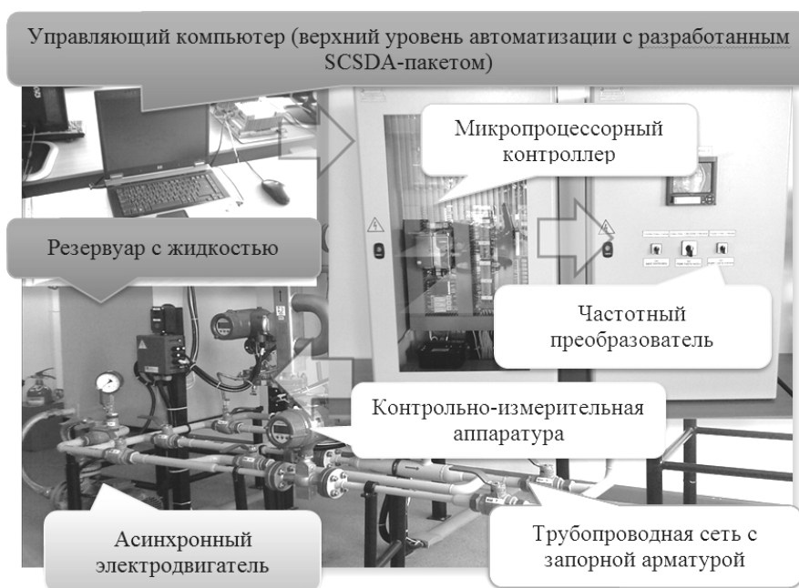
Рис. 1. Экспериментальная установка для исследования работы системы автоматизации транспорта и подготовки нефти
