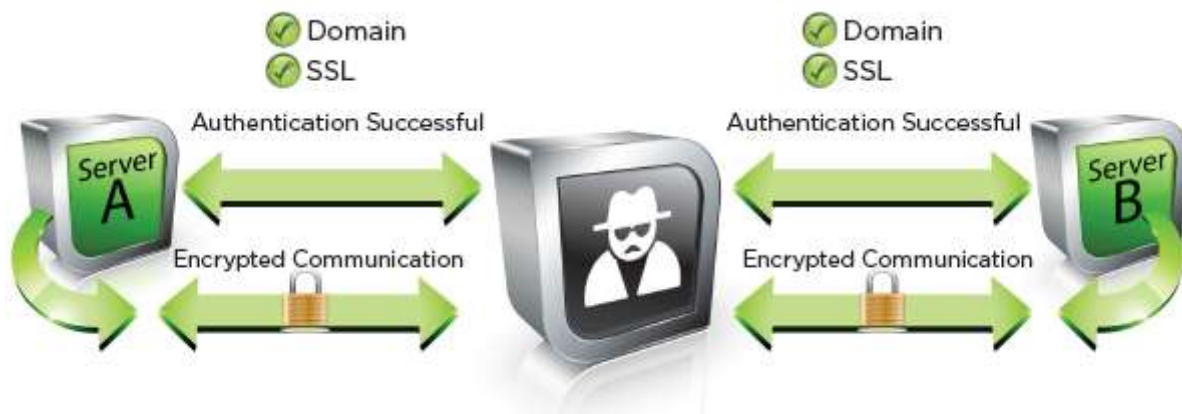
Рис. 5. Схема реализации атаки по хищению трафика аутентификации с помощью MITM “sslstrip”
