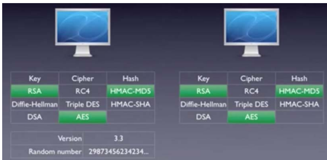
Рис. 4. Процедура «рукопожатия» при SSL/TLS шифровании
