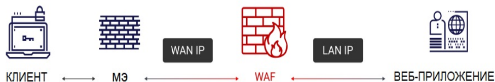
Рис. 1. Размещение межсетевых экранов веб-приложений в сети в режиме обратного прокси-сервера
