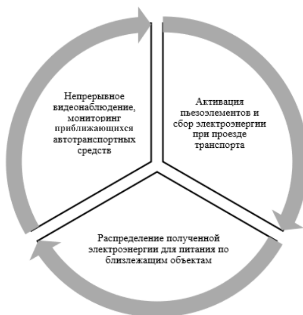
Рис. 6. Принципиальная схема работы системы «I-генератор»
