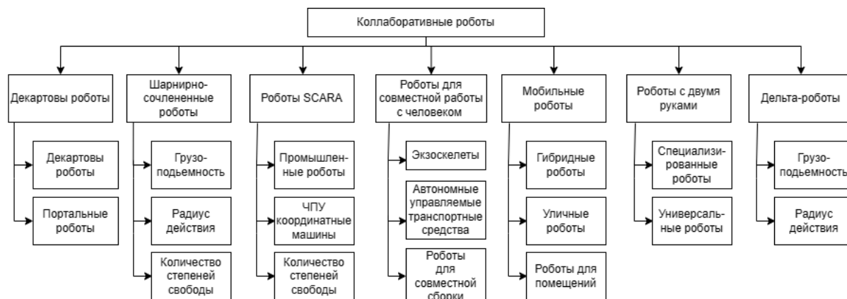
Рис. 1. Классификационная схема коллаборативных роботов
