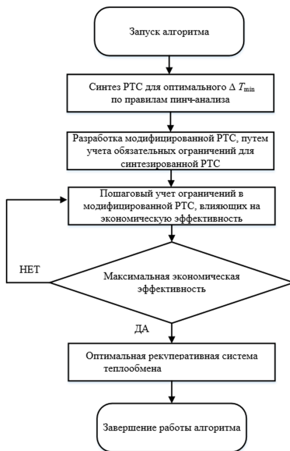
Рис. 1. Блок-схема алгоритма синтеза оптимальной рекуперативной теплообменной системы Fig. 1. Block diagram of the algorithm for synthesizing an optimal recuperative heat exchange system
